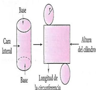
Al efectuar el desarrollo de un cilindro se puede observar que la cara lateral pertenece a un rectángulo cuyo largo es la longitud de la circunferencia que corresponde a la base y cuyo ancho es la altura del cilindro.
