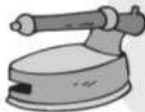
Caja caliente. Provista de un compartimento para carbón.
