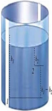
Figura 4. Puntos en un líquido que están a profundidades  $h_1$  y  $h_2$ .
