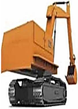
Figura 6. El descubrimiento de Pascal no habría pasado de ser una curiosidad si a alguien no se le hubiera ocurrido conectar dos recipientes de diferente área, aplicar el principio y observar cómo a partir de una pequeña fuerza se obtiene una fuerza mayor.
